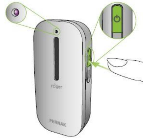
電源ボタンを短く1回押しますと、マイクがミュート状態に切替わります。
