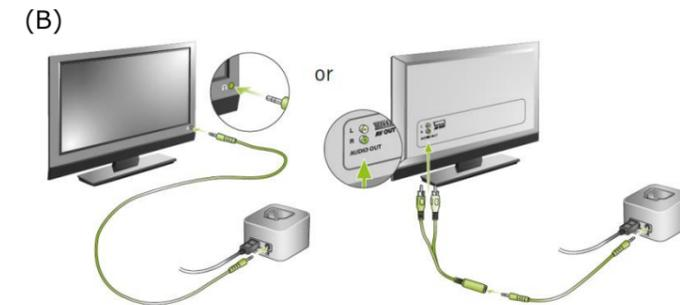
テレビの音声の外部出力の端子形状に合わせてケーブルを使い分けてください。
