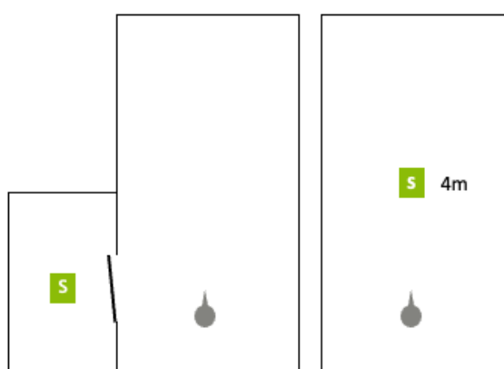
Figuur 2. Installatie voor spreker van aangrenzende ruimte (links) en spreker op afstand (rechts). Groene vierkant met 'S' staat voor de spreker.
