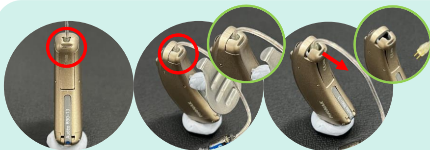
レシーバのくぼみ くぼみに治具を掛け1mm手前に引く 1mmの隙間を開けながら抜く ※カバーを外すことは出来ません
