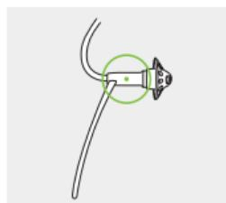
**Многофункциональная кнопка со световым индикатором:** У этой кнопки несколько функций. В зависимости от того, как за-программирован слуховой аппарат, она может служить выключателем, регулято-ром громкости и/или переключателем программ. Это указано в ваших инди-видуальных инструкциях.
