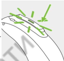
**Телефонные звонки:** Если слуховые аппараты сопря-жены с телефоном по Bluetooth®, коротким нажатием вы сможете принимать, а длительным нажатием – отклонять входящие вызовы.
