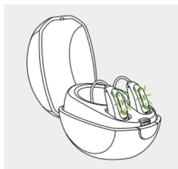
Процесс зарядки автоматически прекратится после полной зарядки аккумуляторов, поэтому слуховые аппараты можно безопасно оставлять в зарядном устройстве. Зарядка слуховых аппаратов может занять до 3 часов. Во время зарядки крышка зарядного устройства может быть закрыта.
