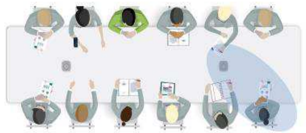
Abbildung 5b: Darstellung eines großen Meetings mit je einem Table Mic II an den beiden Enden des Konferenztisches. Die MultiBeam Technologie wählt und aktiviert die Richtung mit dem besten Signal-Rausch-Abstand (in blau dargestellt). Der Zuhörer ist in grün dargestellt.
