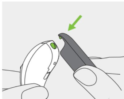
**1.** Posizionare la punta dello strumento nel piccolo foro situato nella parte inferiore del ricevitore.
