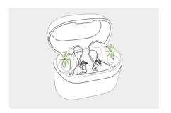
Il processo di carica si interrompe automaticamente quando le batterie sono completamente cariche, quindi gli apparecchi acustici possono essere lasciati nel caricatore in sicurezza. Sono necessarie fino a 3 ore per caricare gli apparecchi acustici. Il coperchio del caricatore deve essere chiuso durante la carica degli apparecchi acustici.
