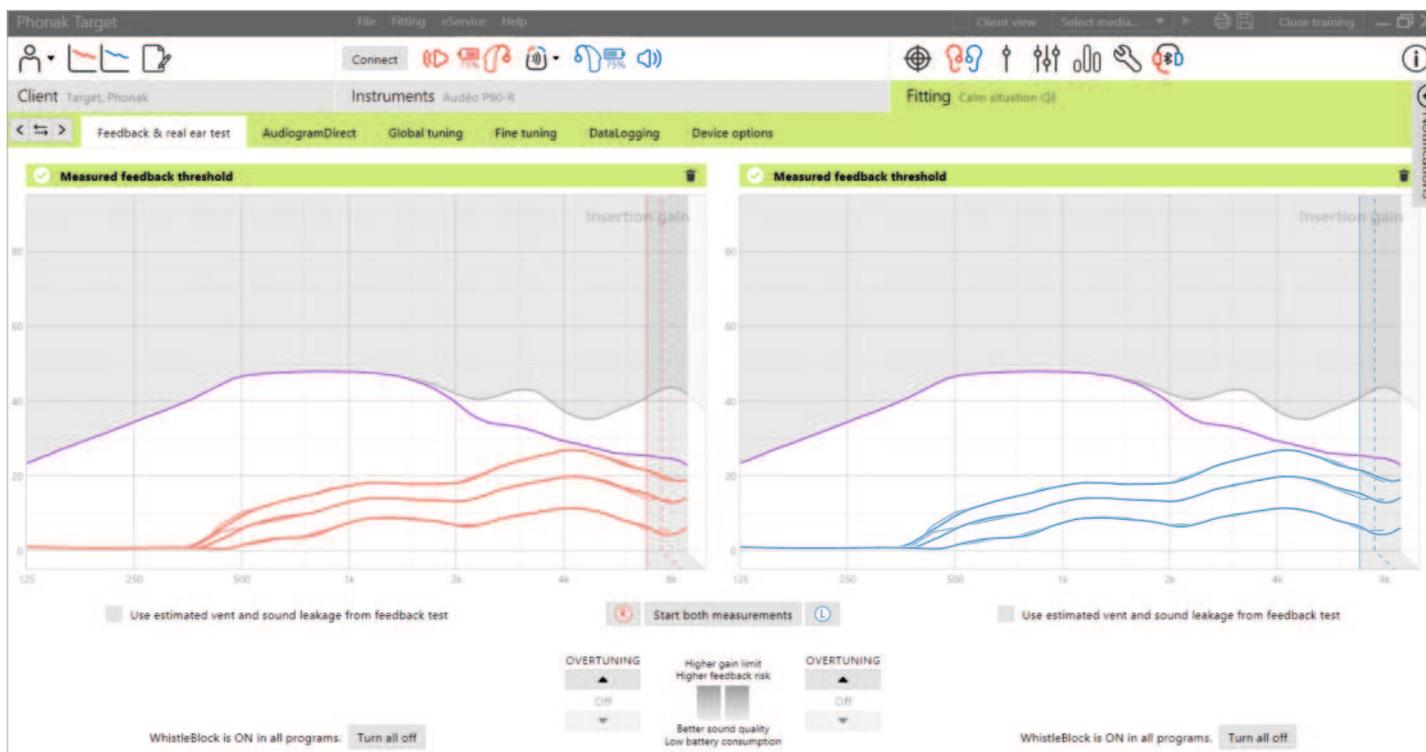
Il est recommandé d'effectuer le test de larsen et de l'oreille réelle lors du premier rendez-vous d'appareillage. Le test peut être exécuté dans les deux oreilles consécutivement ou une oreille à la fois. Le test combine le seuil de larsen individuel, les caractéristiques du conduit auditif du patient et les réglages des paramètres acoustiques pour un calcul d'appareillage plus précis.
