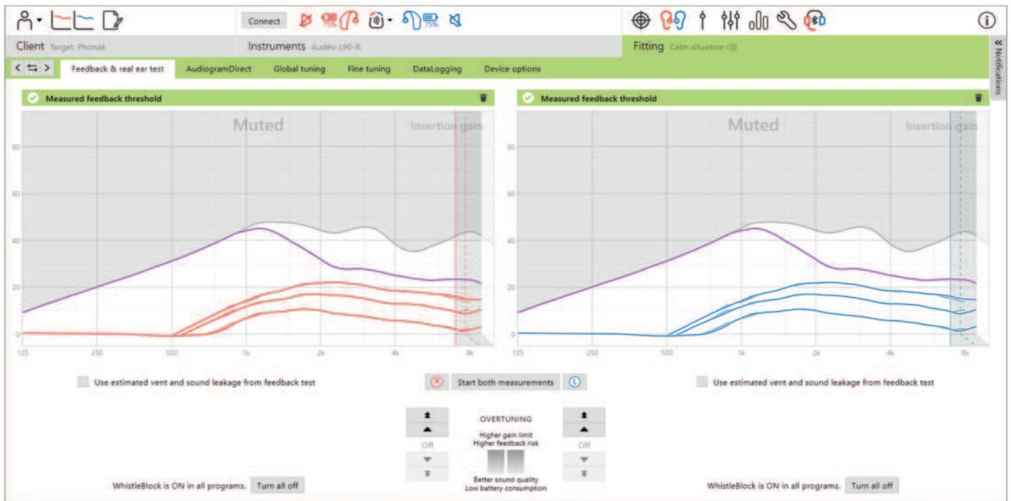
Il est recommandé d'effectuer le test de larsen et de l'oreille réelle lors du premier rendez-vous d'appareillage. Le test peut être effectué dans les deux oreilles consécutivement ou une oreille à la fois. Le test combine le seuil de larsen individuel, les caractéristiques du conduit auditif du patient et les réglages des paramètres acoustiques pour un calcul d'appareillage plus précis.
