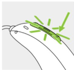
**Appels téléphoniques :** En cas d'appairage avec un téléphone compatible Bluetooth®, une pression brève permet d'accepter un appel entrant et une pression longue permet de rejeter un appel entrant.
