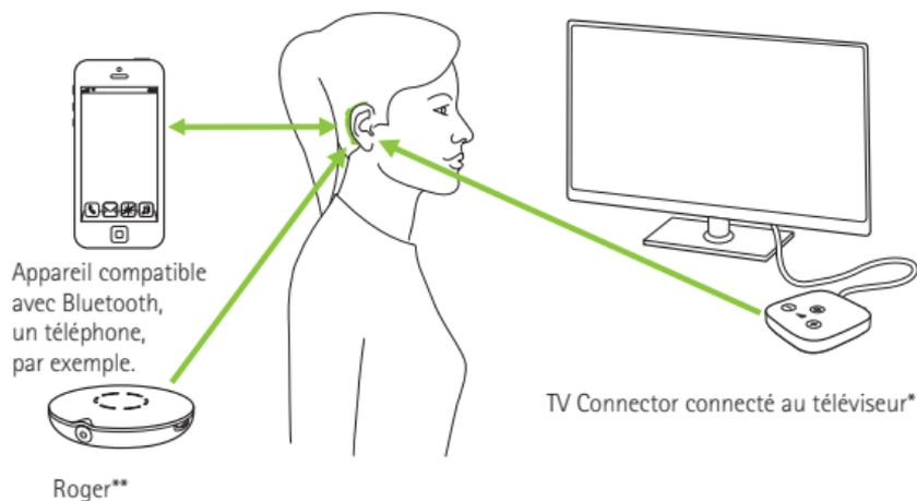
\* Le TV Connector peut être connecté à n'importe quelle source audio telle qu'un téléviseur, un PC ou une chaîne Hi-Fi.
