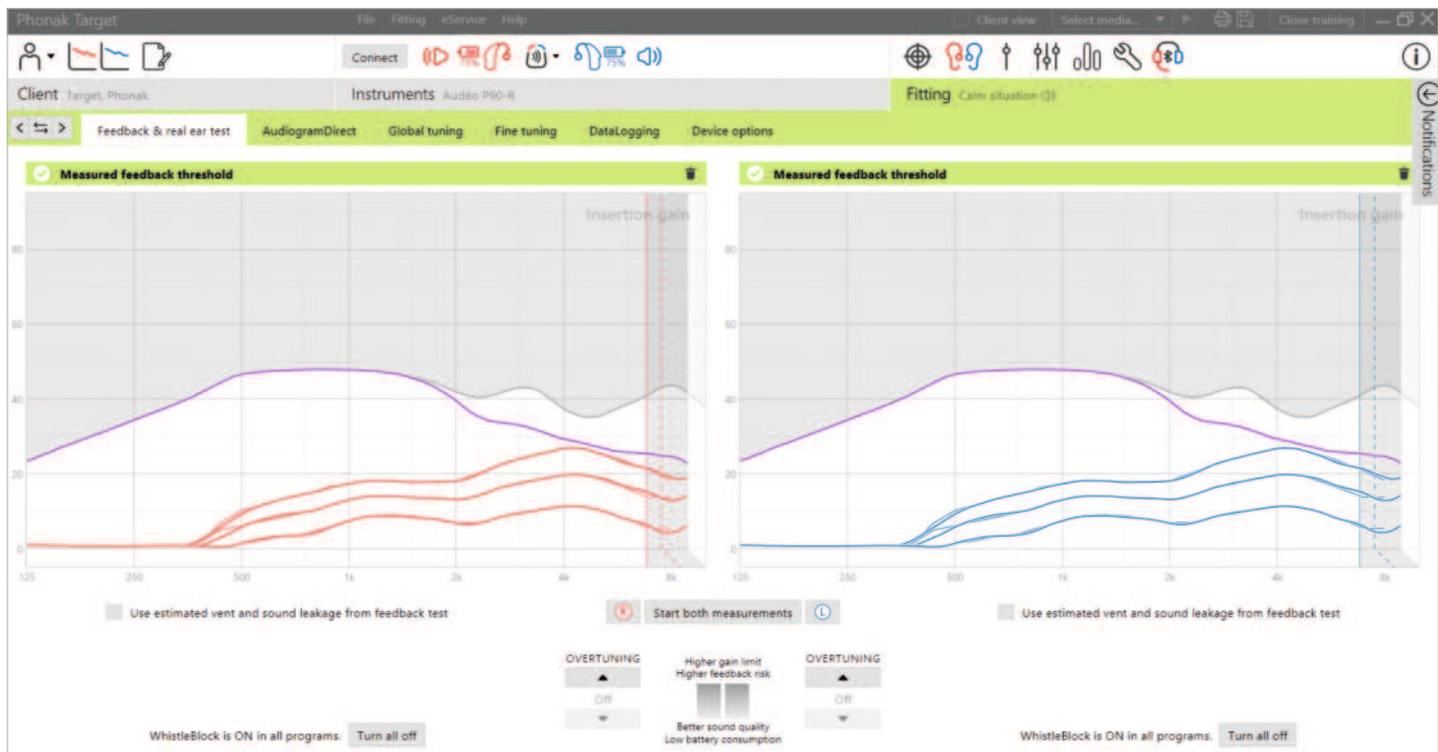
Se recomienda realizar un test de realimentación y oído real en la primera cita de adaptación. Puede realizarse el test en ambos oídos consecutivamente o en un oído cada vez. El test combina el umbral de realimentación individual, las características del conducto auditivo del usuario y la configuración de los parámetros acústicos para un cálculo de la adaptación más preciso.
