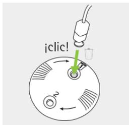
**3.** Para introducir un nuevo protector anticerumen, introduzca con cuidado el auricular en la apertura en la que se ve el nuevo protector anticerumen (frente al icono de la papelera) hasta que encaje. Después de que encaje, verá que la abertura siguiente está vacía y que el nuevo protector anticerumen está dentro del auricular.
