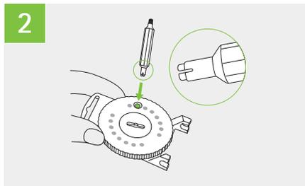
3. Sostenga el auricular con firmeza y sujete la cápsula por el extremo en el que se conecta el cable. Inserte el nuevo filtro anticerumen con suavidad en la abertura de la cápsula.
