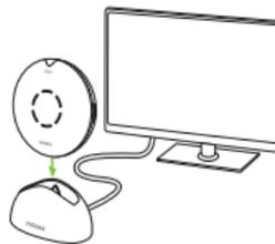
2) Encienda la televisión (o el dispositivo de audio alternativo). El micrófono Roger transmitirá la señal de audio de forma automática a los oídos.
