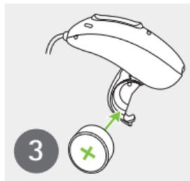
Coloque la pila en la tapa del portapilas con el símbolo "+" hacia arriba.
