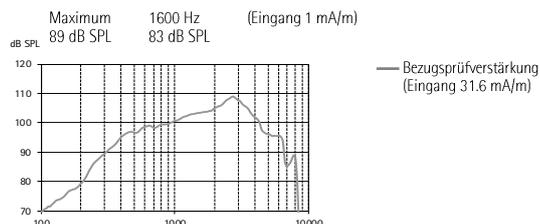
Hinweis: Messungen von digitalen Hörsystemen mit Sinustönen können einen welligen Frequenzgang zur Folge haben. Dieses Artefakt ist auf die Verwendung eines schmalbandigen Eingangssignals zurückzuführen und spiegelt nicht die tatsächliche Leistung bei breitbandigen Eingangssignalen wider.
