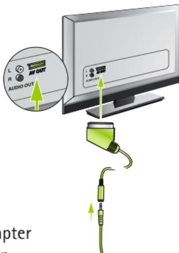
Verbinden Sie das andere Ende des Audiokabels mit dem SCART-Adapter.
