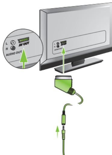
Wenn der Fernseher keinen analogen Audioausgang hat, ist ein Digital-Analog-Wandler erforderlich. Digital-Analog-Wandler sind im Elektrofachhandel erhältlich oder bei jedem Phonak-Händler.
