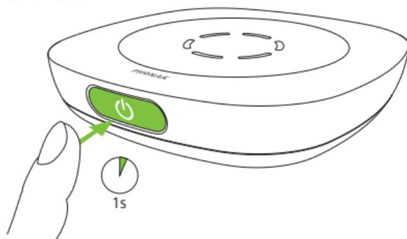
Wenn Ihr Roger-Mikrofon eingeschaltet ist, blinkt die Statusanzeige schwach. Eine grün leuchtende Statusanzeige bedeutet, dass der Akku voll geladen ist. Eine orange leuchtende Statusanzeige bedeutet, dass der Akku halb geladen ist. Wenn die Statusanzeige anfängt, rot zu blinken, muss das Roger-Mikrofon sofort geladen werden.
