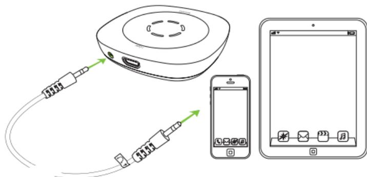
① Nachdem Sie das Audiosignal des Multimedia-Geräts aktiviert haben, erkennt das Roger-Mikrofon dieses und schaltet sein eigenes Mikrofon stumm.
