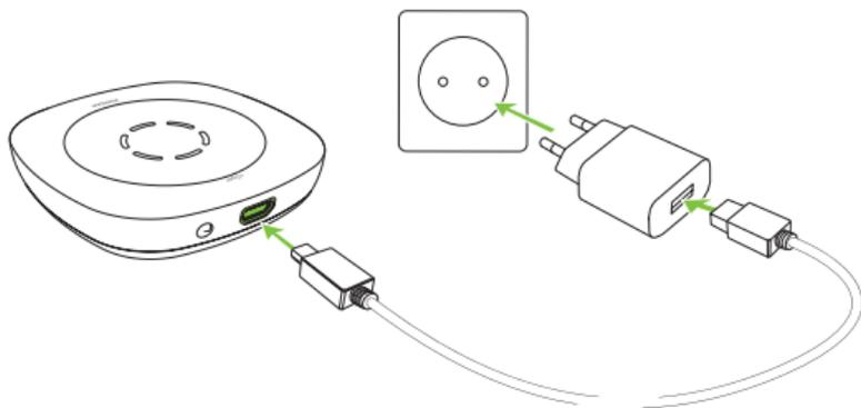
1. Schließen Sie das kleinere Ende des Ladekabels (Micro-USB) am Roger-Mikrofon an.
