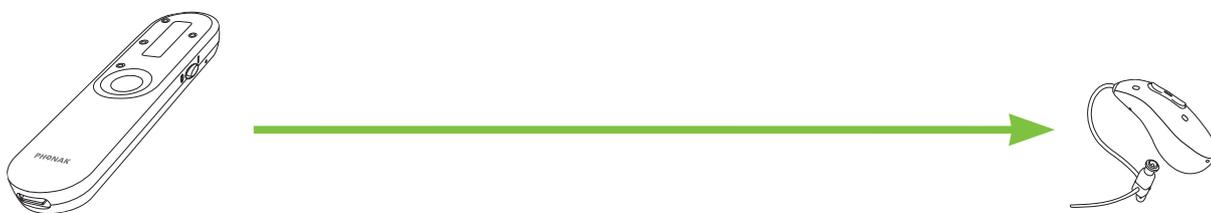
2. **Über einen Roger-Empfänger, der am Hörsystem befestigt ist, oder über NeckLoop:** Hörsysteme können mit einem kompatiblen, konstruktionsseitig integrierten Roger-Empfänger oder einem Roger X verbunden werden, sofern das Hörsystem über einen direkten Audioeingang (DAI) verfügt. Verfügt das Hörsystem über eine T-Spule, kann die Verbindung per Roger NeckLoop hergestellt werden.
