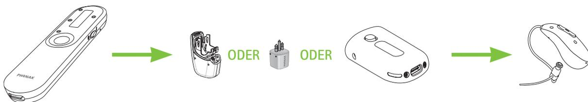
3. **Mit einem Roger-Empfänger, der an ein Streaming-Gerät angeschlossen ist:** Hörsysteme können auch ein Streaming-Gerät des Hörsystemherstellers mit einem direkten Audioeingang (DAI) verwenden, um über einen Roger X Empfänger eine Verbindung mit einem Roger-Mikrofon herzustellen.
