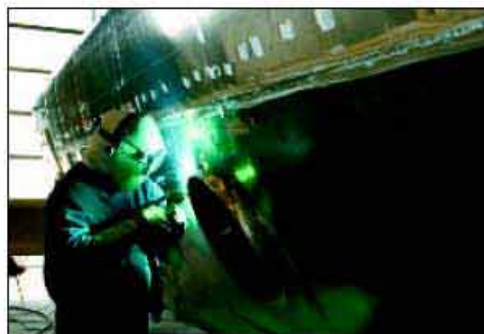
En tankbil produceret til et olieselskab i Norge er ved at tage form. Arne Christensen silber samlingerne af aluminiumspladerne - et arbejde som støjer en del, og derfor er de formstøbte høreværn uundværlige.
